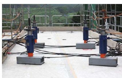
写真-6 頂版スラブ上のジャッキ(加力装置)
