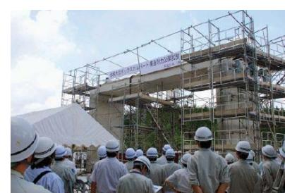
写真-8 静的載荷試験時状況
